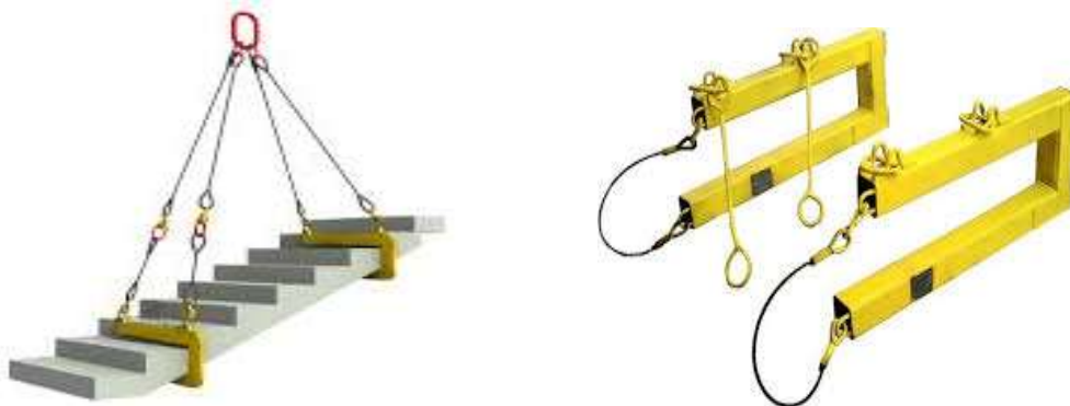
Рис. 2. Стропування сходових маршів вилковими захватами ЗСМ (захват для сходових маршів) шириною до 1500 мм вантажопідйомність до 2,0 т
