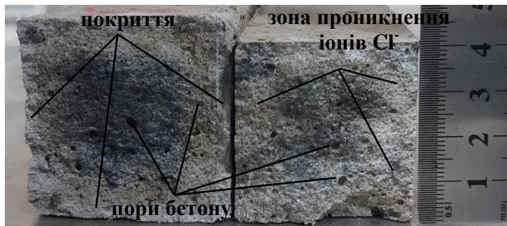
Рис. 1. Фотографії перерізів половинок зразків бетону після розприскування нітрату срібла: з покриттям (ліворуч) і без покриття (праворуч)
