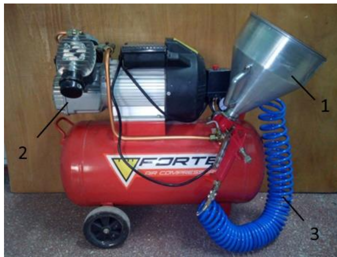
Рис. 1. Комплект мобільного торкретбетонування:
