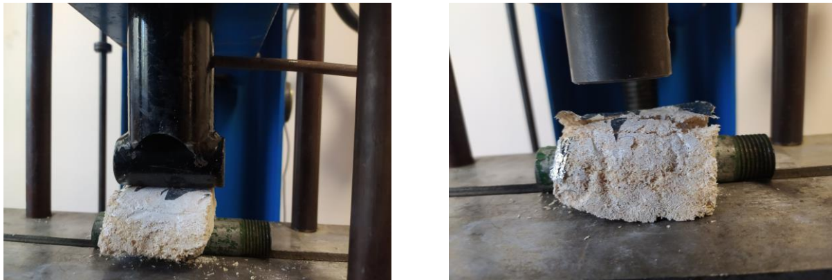
Рис. 2. Дослідження на міцність теплоізоляційних виробів з деревини
