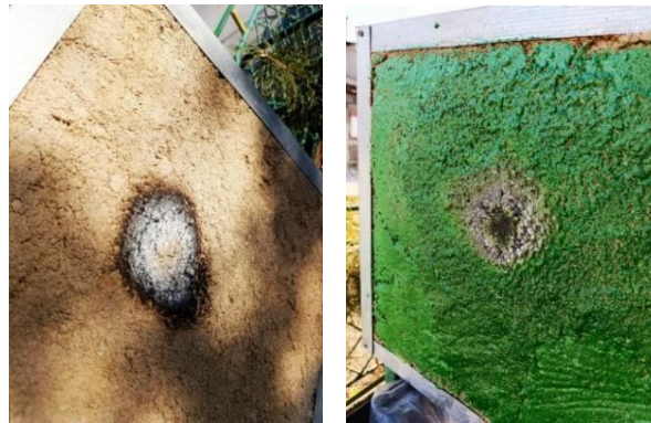
Рис. 4. Зразки еко-арболітобетону після вогневого впливу 120 секунд, 1400°C
