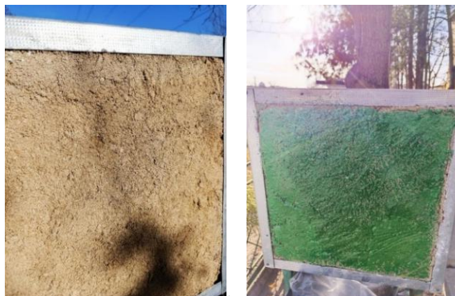
Рис. 1. Поверхні зразків еко-арболітобетону до іспитів (без обробки та з обробкою поліфункціональним модифікатором)
