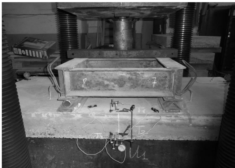
Рис. 2. Схема передачі навантаження та місця встановлення приладів при проведенні випробувань зразків
