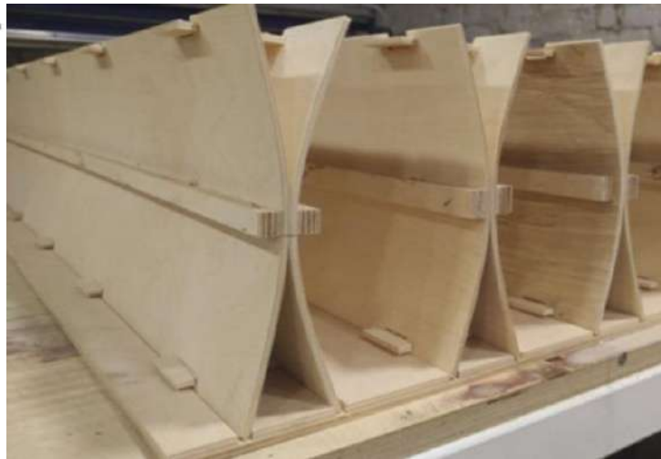
б) розташування ребер у обшивці панелі перед вклеюванням
