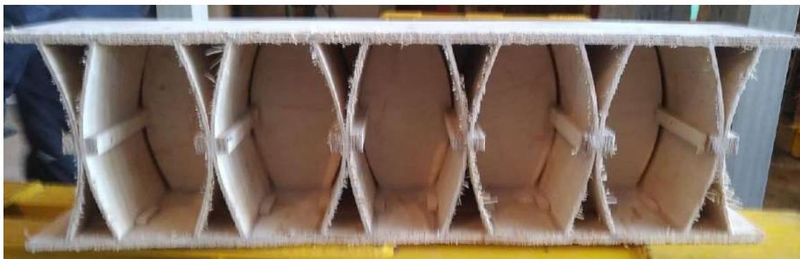
д) переріз панелі після випробувань
