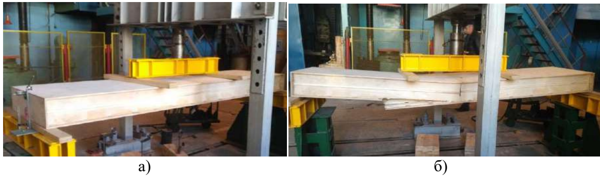
Рис. 5. Загальний вид панелі перед випробуванням (а) та після руйнування (б)
