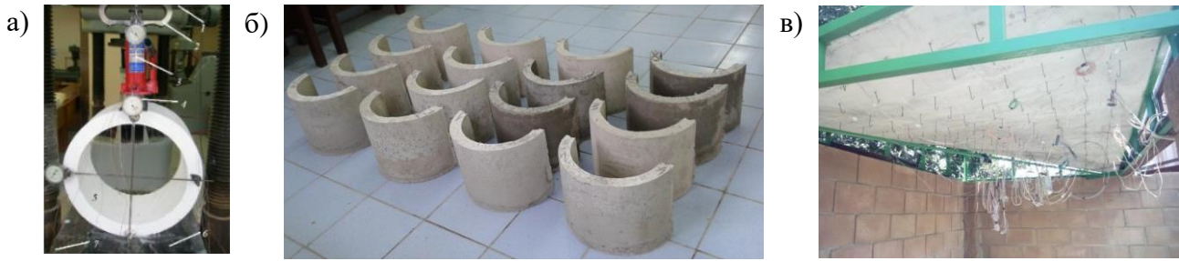
Рис. 2. Дослідження СФБ-конструкцій в ЛНТУ: а – безнапірні труби; б – лотки для водовідведення; в – оболонки-гіпари
