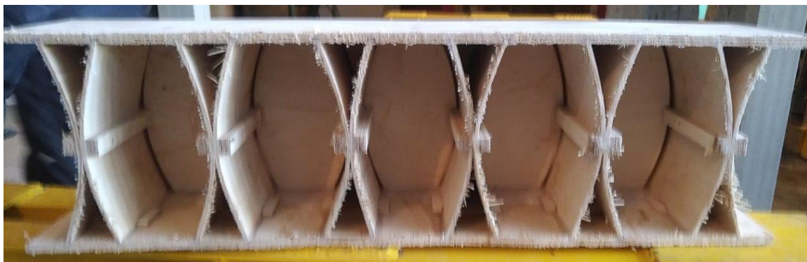
д) переріз панелі після випробувань
