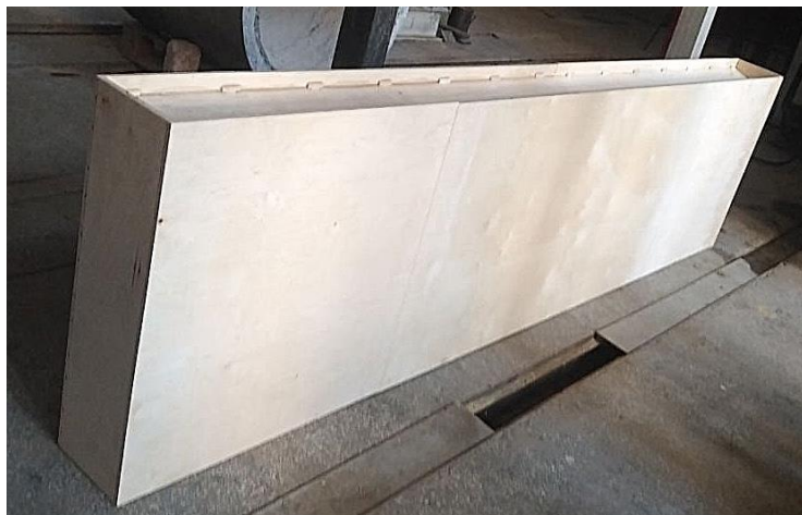
г) загальний вид панелі з торцевими ребрами перед випробуванням
