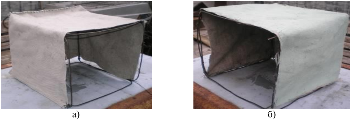
Рис. 2. Модельні зразки елементів намету, виготовлених з парусинової тканини: а – необроблений; б – оброблений вогнезахисним інтумесцентним покриттям
