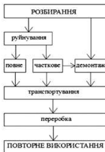
Рис. 1. Склад комплексного процесу розбирання будівельних конструкцій
