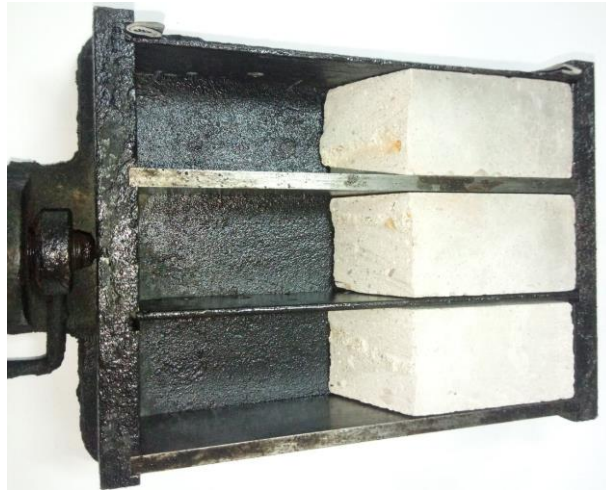
Рис. 2. Форма з половинками зразка
